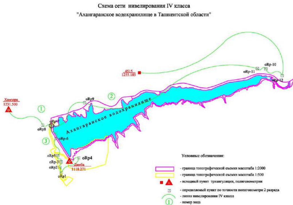
Рис.2. Схема сети нивелирования IV класса
